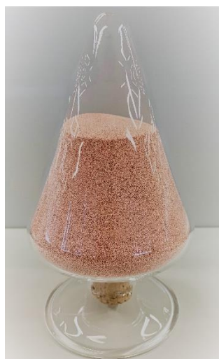
写真2：3Dプリンター用銅クロム合金粉
