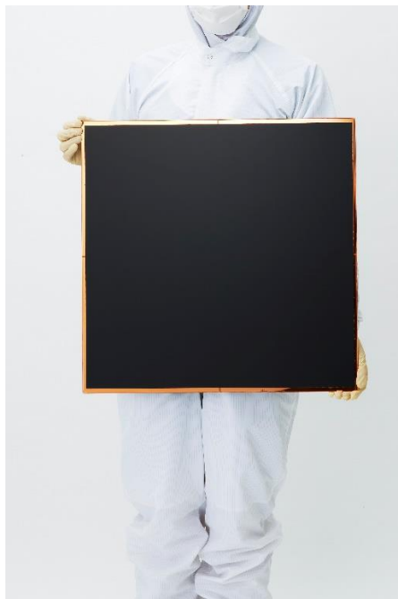
写真 2 : 600mm パネル形状 HRDP®製品を用いたモールド樹脂封止後の 半導体パッケージ作製中の基板 (ライン/スペース 2/2 \mu m RDL ※4 適用品)
