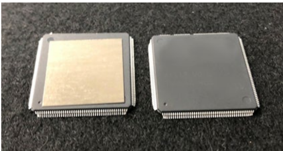
ガドリニウム金属箔の使用例 (左：半導体チップへの貼付)
