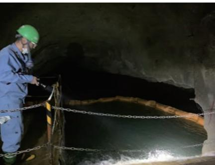
[左] 神岡鉱山の坑内にあります坑内水処理用の4,000t沈殿池(神岡鉱業)。
