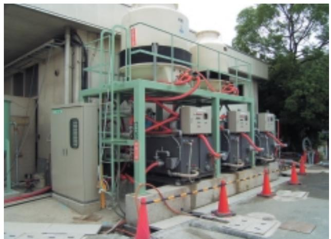
稼働中の加熱吸引法装置
