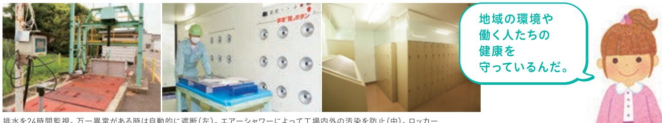
排水を24時間監視。万一異常がある時は自動的に遮断(左)。エアーシャワーによって工場内外の汚染を防止(中)。ロッカールームにも集塵装置を設置(右)。地域の環境保全、従業員の安全衛生の徹底を図っています。
