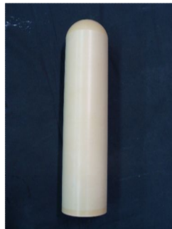
図 1 試作した金属溶湯用管状部材 (直径 82 mm 長さ 370 mm)
