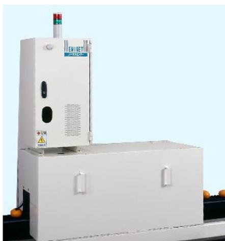
※下部のコンベア上に並んだ黒い円盤に青果物を乗せ装置内部を通過させ測定します。
