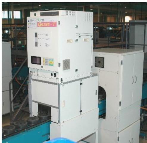
エミネット製青果物非破壊内部品質センサー
